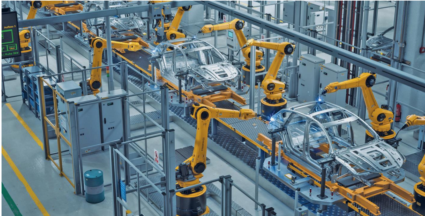
Figura 6.5. El big data está cada vez más presente en las fábricas. Mediante sensores conectados a los brazos robóticos se recogen datos en tiempo real.
